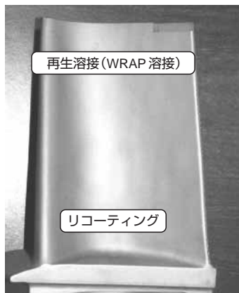
図3. ガスタービン第1動翼のリコーティング — 翼表面と冷却空気孔にコーティングを施工した。
