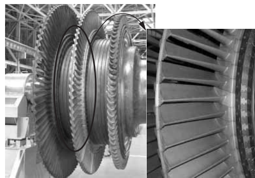
図5. HIP 再生処理翼の実機組込状況 — HIP 再生処理した第2段動翼を実機へ挿入した。
