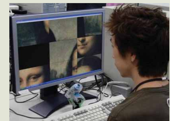
図5. 視線検出の応用例 — ディスプレイ上のピースを見るだけで動かすことができるパズルの例です。
