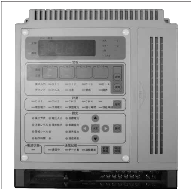
図1. デマンド監視装置 — 現場での操作性を考慮し、パネル上でのデマンド値表示や設定値変更などができるよう、小型で多機能一体型の設計としている。
