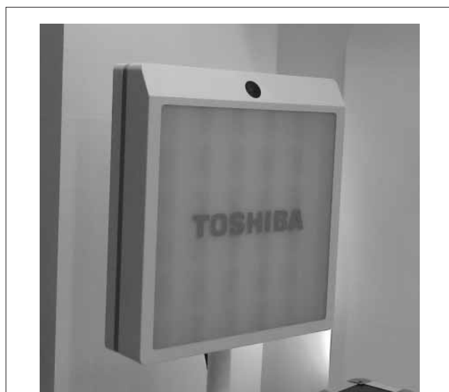
図5. 電波発射源可視化装置の空中線部 — 空中線部の上部にカメラを装着している。
