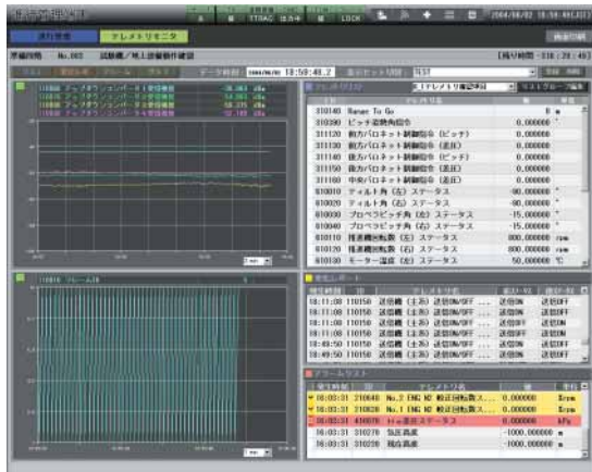
図 8. 監視情報表示用画面 — 画面のカスタマイズや注意喚起表示が可能である。
