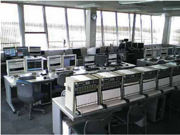
図5. 追跡管制用端末 — 手前から二列目が2画面構成の追跡管制用端末である。 Terminals of integrated SPF tracking and control system
