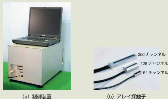
図2. フェーズドアレイ超音波探傷装置 — フェーズドアレイ超音波探傷装置は、制御装置とアレイ探触子から成り、256、128、64チャンネル(振動子の数)などのアレイ探触子があります。
