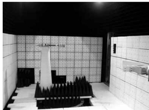
図7 マルチバンド対応3次元放射特性測定装置 — マルチバンドアンテナの複数周波数帯の3次元放射指向性と放射効率を約2分間で評価できる。
