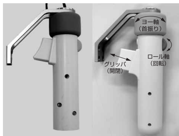
図5. 新型操作部一次試作(左)と二次試作(右) — 試作と評価を繰り返すことで操作性の向上を図った。
