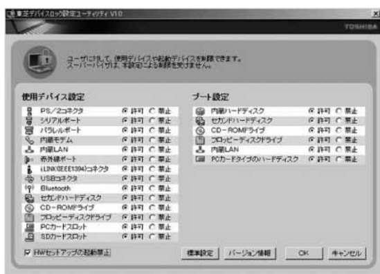
図3. デバイスロックユーティリティ設定画面 — ロック可能なすべての設定項目を表示している。
