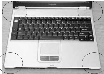
図8. ショックプロテクタ (dynabook SS LX) — 筐体の四隅を膨らまし、落下衝突時に膨らみが変形することによって内部に伝わる衝撃を低減する。
