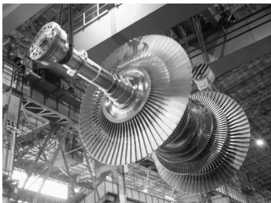
図7. 48インチ用低圧ロータ—イタリアエジソン社のトルビスコサプロジェクト向け主タービン低圧ロータにおいては、最終段に48インチ翼を適用している。
