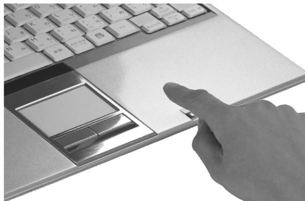
図8. 指紋認証装置 — 指紋認証の採用により、ユーザーはめんどうなパスワード管理から解放されるとともに、安定な指先情報を利用した高精度な認証により安全性を高め、かつ、操作性を向上させる。
