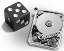
図5. 超小型HDD MK2001MTN — 世界で初めての0.85型HDDである。
