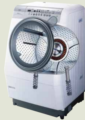
図1. S-DDモータ搭載洗濯乾燥機 — 48極S-DDモータをDSP制御で滑らかに回転させ低騒音化を図りました。
