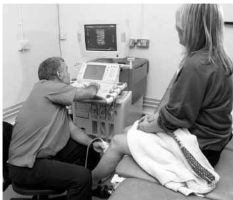
図10. IASSIST™ コントローラーを使用しない従来例 — 操作者は左右の手を交差させた無理な姿勢をとらざるをえず、身体的負担が大きい。患者の位置や姿勢も装置に近づくように制約される。
