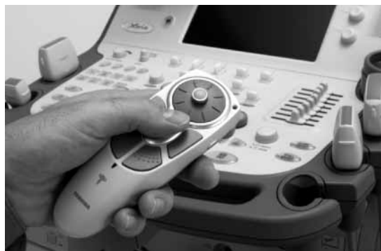
図9. IASSIST™ コントローラー — これにより、操作パネルが遠隔操作できる。
