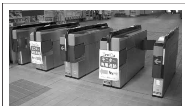
図3. ICカード専用自動改札機 — 上部にICカードの読取り、書込みを行うICカード処理部を設ける。写真は瓦町駅本屋口設置機である。
