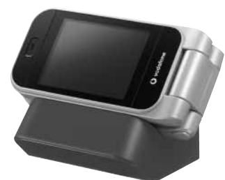
図 3. 縦横共用卓上ホルダー—通常の縦置きでの充電に加え、携帯電話機を 360° 開き横向きにする TV ビュースタイルでは画面が見やすくなるよう、立て掛けた状態で装着できる構造としている。
