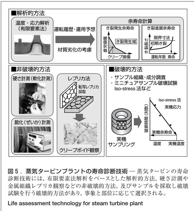
図5. 蒸気タービンプラントの寿命診断技術 — 蒸気タービンの寿命診断技術には、有限要素法解析をベースとした解析的方法、硬さ計測や金属組織レプリカ観察などの非破壊的方法、及びサンプルを採取し破壊試験を行う破壊的方法があり、事象と部位に応じて選択される。
