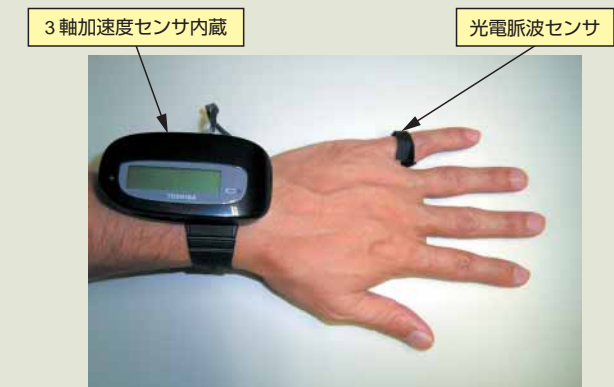
図4. 腕時計型睡眠センサ — 腕時計本体に3軸加速度センサを内蔵し、指先のセンサヘッドに光電脈波センサを内蔵します。
