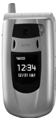
図2. Bluetooth™搭載携帯電話 W21T — データ受信などの機能を追加した Bluetooth™搭載携帯電話である。
