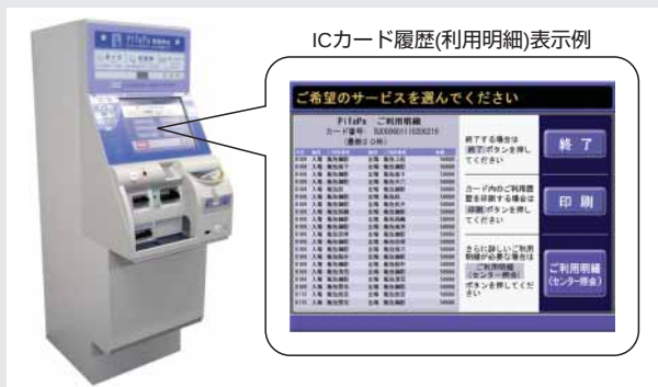
▲PiTaPa IC カードシステム対応自動券売機と IC カード履歴表示例 Automatic ticket vending machine handling PiTaPa IC card system (with display of fare payment record)
