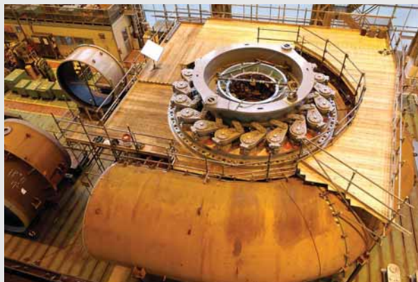
▲インド プルリア揚水発電所ポンプ水車 初号機工場仮組立て Shop assembly of pump-turbine for Purulia Pumped Storage Power Station, India
