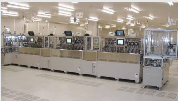
▲モバイル液晶モジュール用 COG ライン Manufacturing line using COG process for mobile LCD modules
