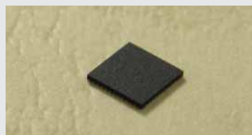
▲受信 IC 及び送信 IC (VQON44) 外形寸法 : 5.3 × 5.3 × 0.6 mm Receiver and transmitter IC (VQON44)
