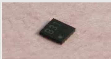
▲低雑音増幅器 IC (TQON16) 外形寸法 : 2.4 × 2.4 × 0.5 mm Low-noise amplifier (TQON16)
