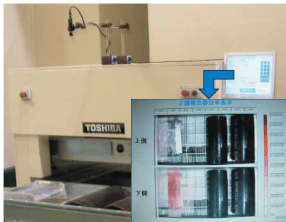
トレイ型クリアランスレベル測定装置と汚染分布測定結果の表示例
