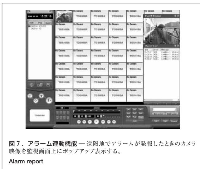
図7. アラーム連動機能—遠隔地でアラームが発報したときのカメラ映像を監視画面上にポップアップ表示する。
