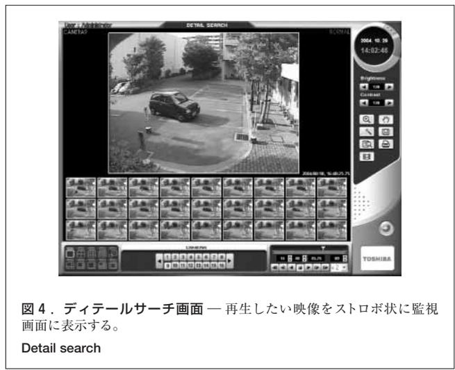
図4. ディテールサーチ画面 — 再生したい映像をストロボ状に監視画面に表示する。
