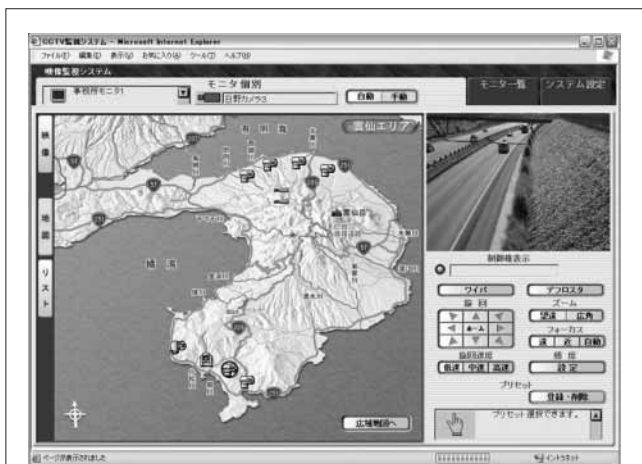
図4. 操作画面例 — 地図上からカメラを選択し、制御を行う。 Example of control terminal display
