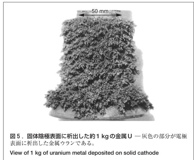
図5 固体陰極表面に析出した約1kgの金属U — 灰色の部分電極表面に析出した金属ウランである。
