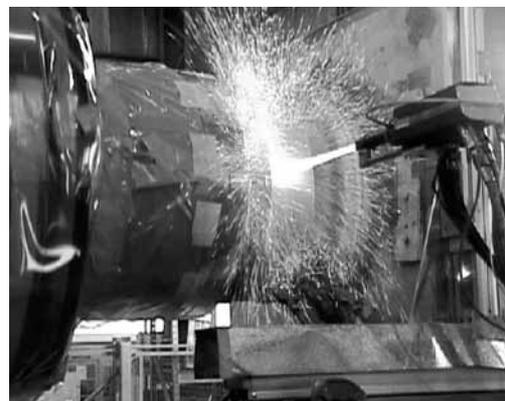
図6. ロータシール部の現地溶射補修 — ロータ水素シール部の傷を現地にて補修する技術を確認した。
