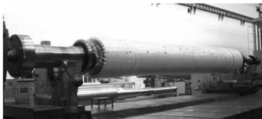
図5. 945 MVA 発電機用ロータ — 1,000 MW 級大容量発電機の製作実績に基づき、既設の不適合を解決した予備ロータを納入した。
