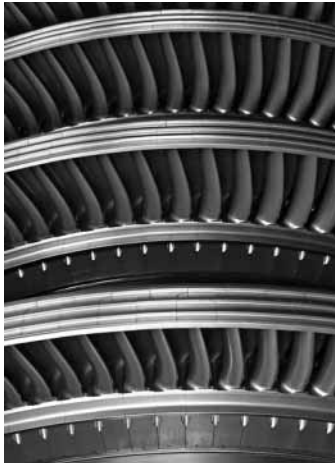
図1. 改良型翼列 — 3D流体解析に基づき、二次流れ損失を低減させるように羽根通路部の形状を改善した。 Array of advanced blades
