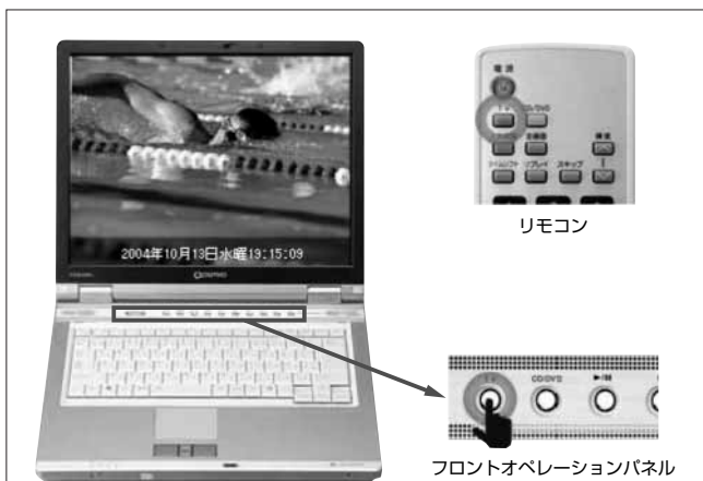
図7. フロントオペレーションパネルとリモコン — QosmioPlayerやQosmioUIの起動と操作を行うことができる。 Front operation panel and remote controller
