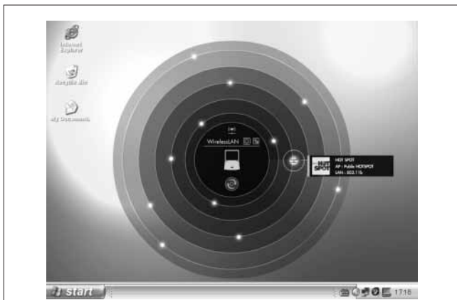
図2. ワイヤレスデバイス検索機能 — デスクトップ上に円形の仮想空間を表示し、検出された無線デバイスが漂う世界を展開する。デバイスは、中心に近いほど電波強度が強いことを示す。 Search for wireless device
