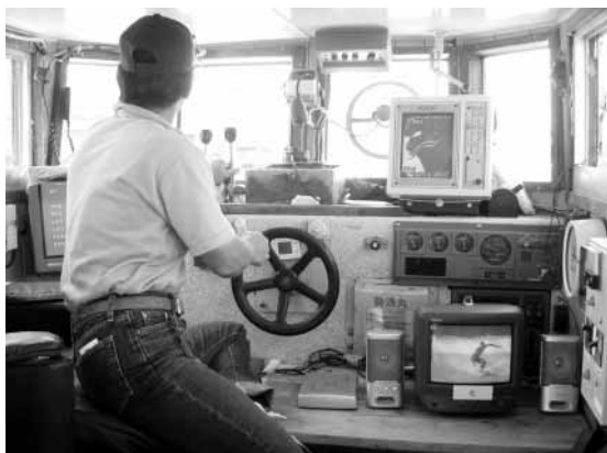
図4. 操縦室での受信状況 — 操縦室に設置された受信システム(右下の受信ユニット, モニタ, スピーカ)では, まったく乱れない映像と音声を確認された。
