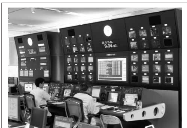
図2. 監視卓 — 最大映像9チャンネル、音声60チャンネルを監視することのできる監視卓である。人間系の監視以外に、信号異常を自動で検知する機能を備えている。
