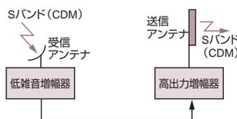
図C. リピータ型ギャップフィルター — 衛星からの放送波を直接受信し、そのまま増幅して送信するギャップフィルターである。
