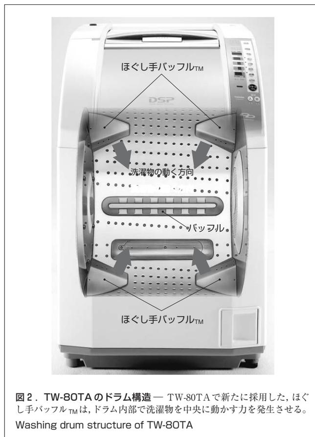
図2. TW-80TAのドラム構造 — TW-80TAで新たに採用した、ほぐし手バッフル™は、ドラム内部で洗濯物を中央に動かす力を発生させる。
