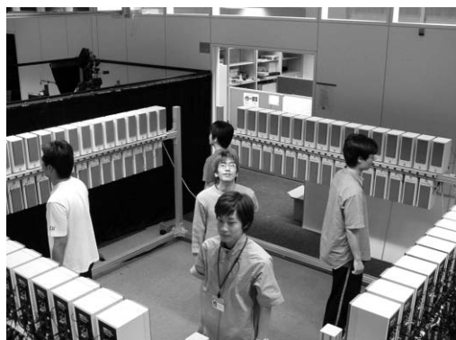
図2. 構築したスピーカアレーの外観 — 一辺が約3mの正方形配置である。一辺に32台のスピーカが付いている。
