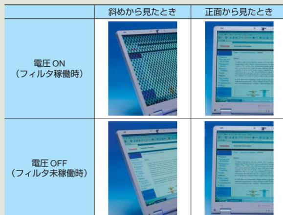
図1. PCに組み込んだフィルタ—電圧OFF時は通常の液晶ディスプレイとして使用できる(下)。フィルタに電圧をONすると、斜めからのぞき込んだ場合には市松模様状の妨害パターンが発生し液晶画面の内容が読み取れなくなる(上左)が、正面からの見え方は変わらない(上右)。
