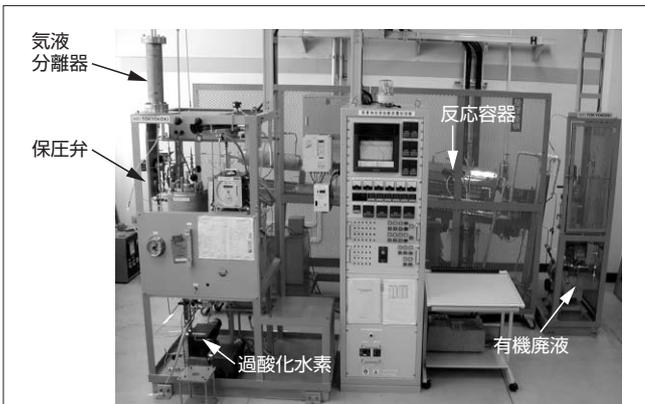
図5. 連続分解試験装置 — 有機廃液の分解特性と装置特性を調査できる。
