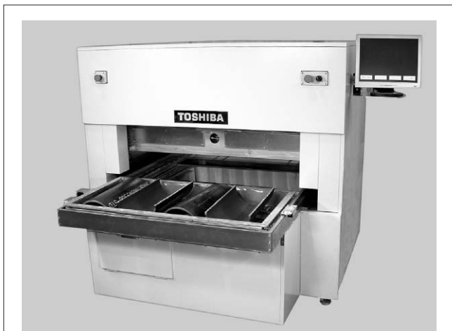
図1. トレイ型測定装置——一体化された装置の外観を示す。トレイ上に複数の半割配管がセットされ、これから測定に入るところである。 Tray type clearance level monitor
