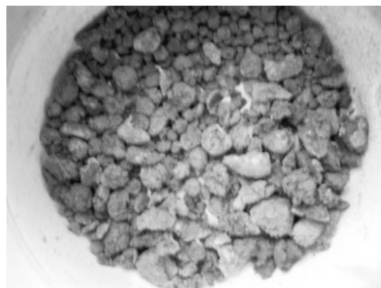
図6. 乾燥汚泥 — 乾燥汚泥は粒形状で取り扱いやすい。 Dried sludge
