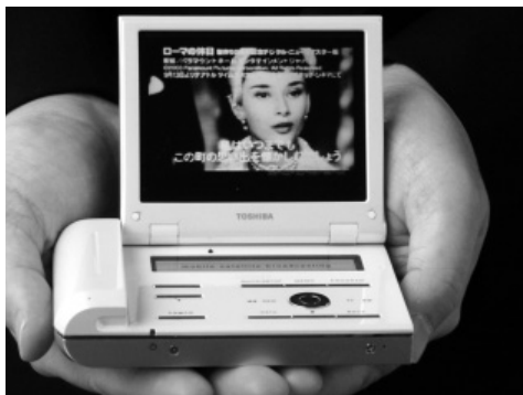
図9. 小型携帯端末 — 3.5型の液晶ディスプレイ付きでサイズは75(縦)×112(横)×22(高さ)mm, 質量約200g(バッテリー, アンテナ内蔵)の手のひらサイズである。
