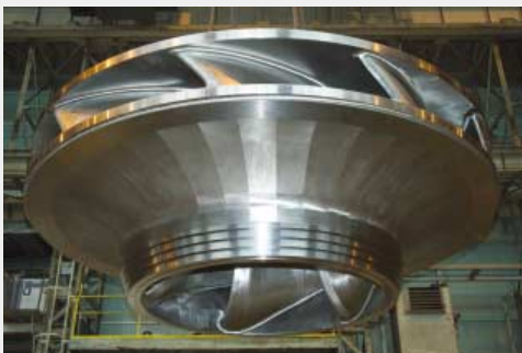
神流川発電所向けスプリッターランナ Splitter runner for Kannagawa Pumped Storage Power Station
