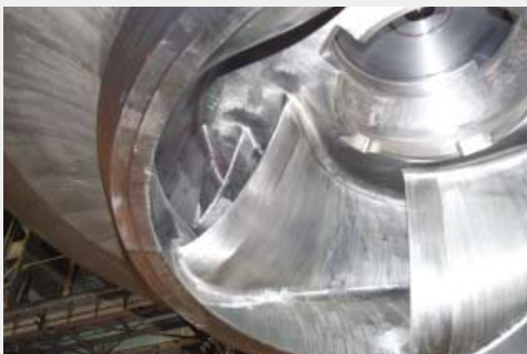
神流川発電所向けランナ長翼(手前)と中間翼(奥) Long blade (front) and splitter blade (rear)
