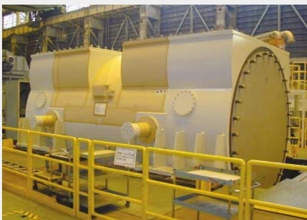
出荷直前の発電機固定子 Generator stator ready for shipment
