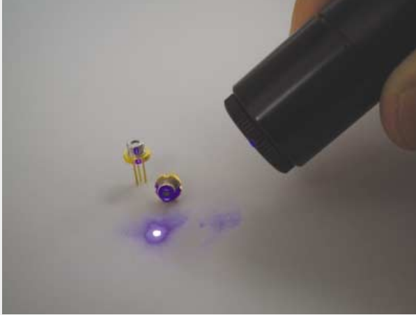
青紫色半導体レーザー GaN-based blue-violet laser
