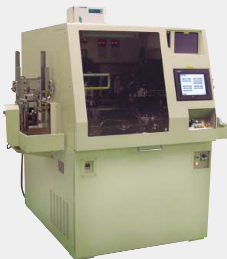
超音波フリップチップボンダ Ultrasonic flip chip bonder
