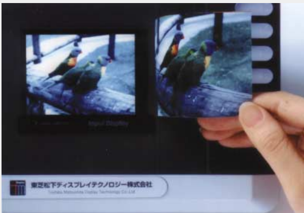
世界初のカラー画像を読み込める“インプットディスプレイ” World's first input display with color image capturing function
