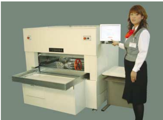
クリアランスレベル測定装置の外観 Measuring system for confirmation of clearance level
