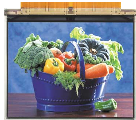
小型AV用 3.5型QVGA OLED ディスプレイ 3.5-inch diagonal organic light-emitting diode (OLED) display for mobile AV application
