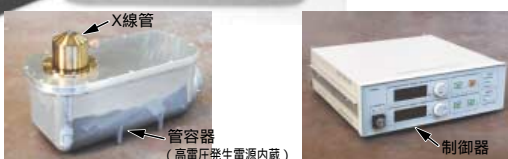
ボンディングワイヤ透視画像(上)と透過型マイクロフォーカスX線発生器(下)
