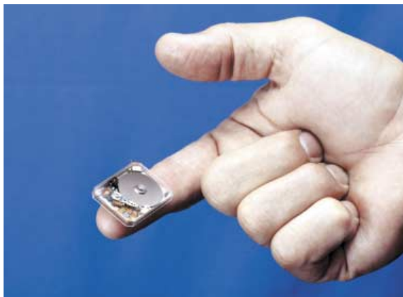
0.85型HDD(モックアップ) 0.85-inch hard disk drive (mock-up)
