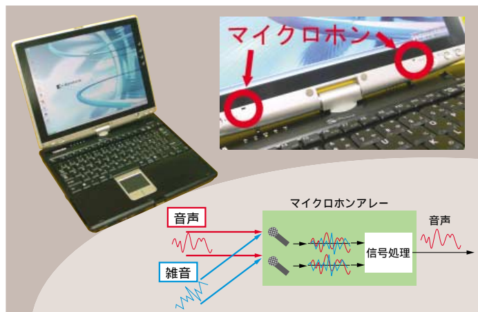
マイクロホンアレーの原理と搭載予定のタブレットPC(試作機) Schematic of microphone array and tablet PC (experimental model)
