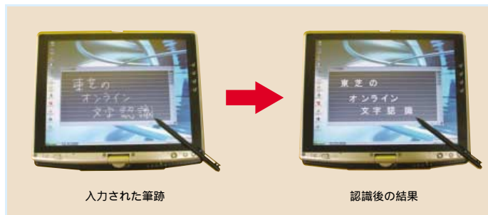
タブレットPCのオンライン文字認識技術による変換例 Operation of online handwritten string recognition system on tablet PC
