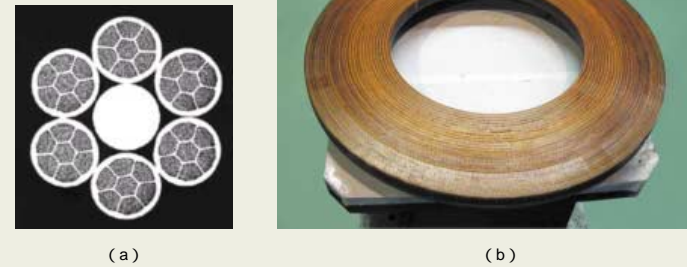
図3. 高温超電導線と高温超電導コイル - 中部電力(株)と昭和電線電纜(株)が共同開発したBi2212線材の断面(a)と、この線材を用いた1 MVA級高温超電導SMES用の要素コイル(内径360 mm) (b)を示します。
