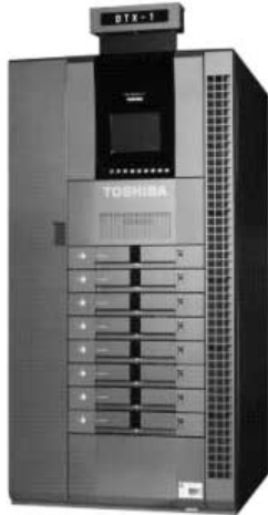
図4 . 1 kW 空冷デジタル送信機 - 電力増幅器8台(標準は6台)で構成されるファン方式の1 kW 送信機で,電力増幅器の数を増やすことで,1台故障時でも定格出力,性能を維持できる。 1 kW digital transmitter
