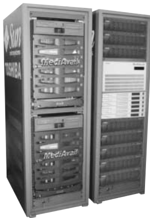
図4 . MediAvail™ - ハードディスクを記録媒体に用いており、長時間素材の送出システム用ビデオサーバとして位置づけられている。 MediAvail™ hard disk video server
